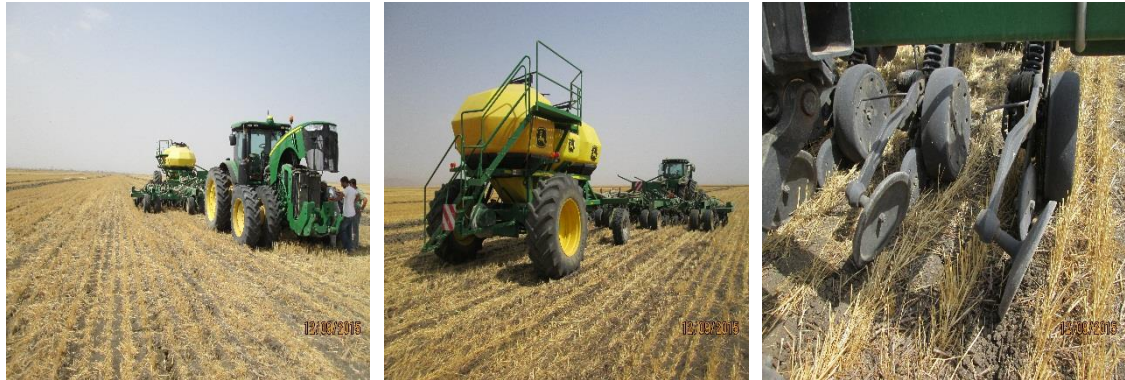
Şekil 3.4. No-Till (doğrudan ekim) ekim makinesi.
